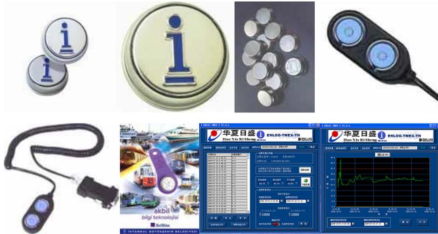
Thermochron® iButton®是一种坚固的自主系统，测量温度并将结果记录在受保护的存储器单元中。以用户定义的速率记录温度。器件存储多达 2048 个等间隔(范围 1 至 255 分钟)测量的温度值。如果温度超出用户设定的范围，还会记录该情况发生的时间、温度停留在允许范围以外的时间、以及温度是否过高或过低。另外还有 512 字节的读/写非易失存储器，可用于存储所附物体的相关信息。出厂时利用激光光刻写入芯片的 64 位注册号，用来保证其绝对可溯性。
